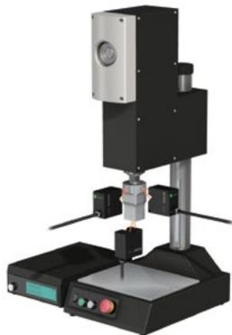
测量超声波拼接机的喇叭振动。可以确认在更换喇叭时是否达到了规定的振幅量。由于是小型感测头，拆装简单，可利用 392 kHz 的超高速采样正确测量。
