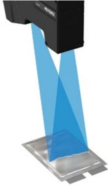
测量电池的充放电试验时的膨胀变化。通过安全方面的评价等，可以掌握在内部发生异常时，随着时间会发生什么样的形状变化。
