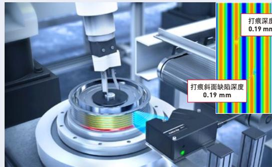
滑轮的形状测量、打痕检测
