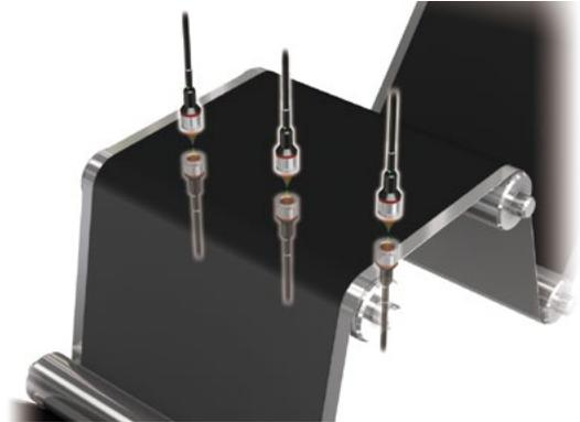
非接触地测量电极涂敷后的厚度。可高精度地测量有光泽金属薄片与表面粗糙的涂敷面等各种材质。
