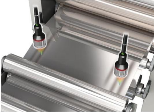
检测涂胶前的金属薄片晃动。如果是具有良好角度特性的 CL 系列，即使金属薄片有晃动，也可以正常测量，所以可提高涂胶质量。
