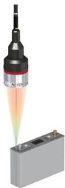
在盖子焊接前检测盖子有无翘曲。CL 系列采用同轴方式的测量原理，因此即使是有光泽的铝，也可以稳定测量。
