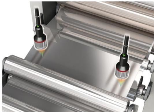
检测缝口装置上的电极晃动。如果是具有良好角度特性的 CL 系列，即使电极有晃动，也可以正常测量。
