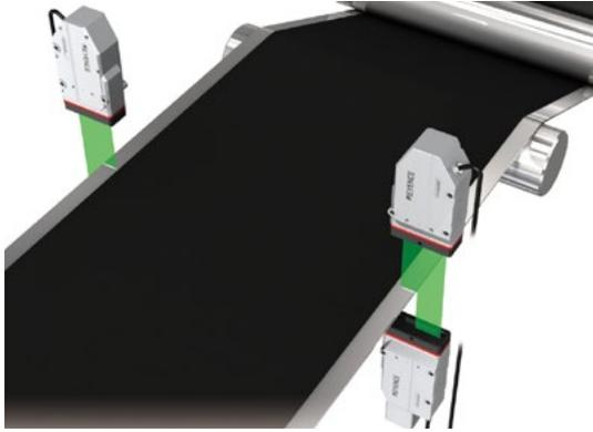
检测卷绕前的电极弯曲，进行反馈控制。即使生产线速度高，如果是每秒 16000 次采样的 LS 系列，也能稳定检测。
