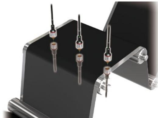
测量冲压后的电极厚度。提供用于夹住上下传感头的专用夹具，消除了光轴偏差引起的误差影响。可简单安装，高精度测量。
