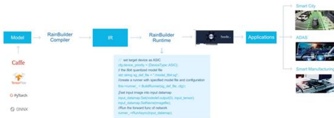
图 6-4 使用 RainBuilder 进行算法部署与集成流程示意图
